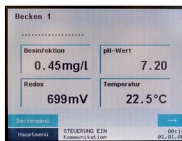
Автоматическая контрольно-регулирующая станция GENO®-CPR-tronic 02 family берет на себя функцию постоянного контроля за дезинфекцией и уровнем pH в Вашем бассейне.
