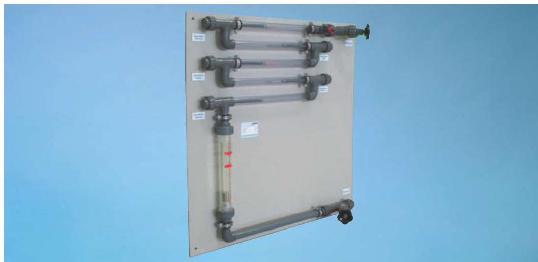
Участок измерения коррозии
