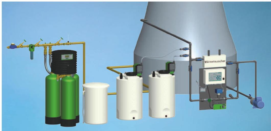
Пример монтажа установок подготовки охлаждающей воды
