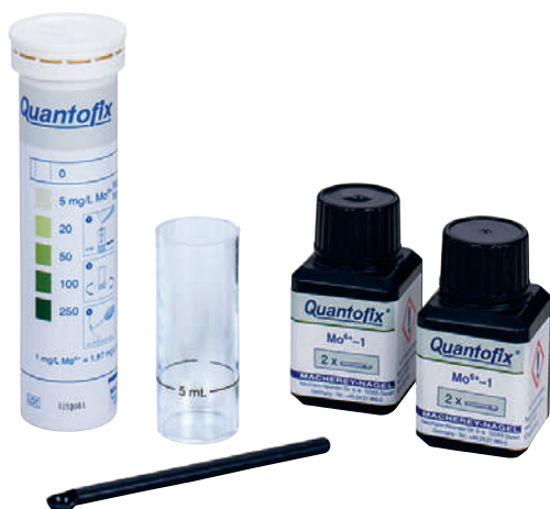
Устройство контроля за содержанием молибдена
